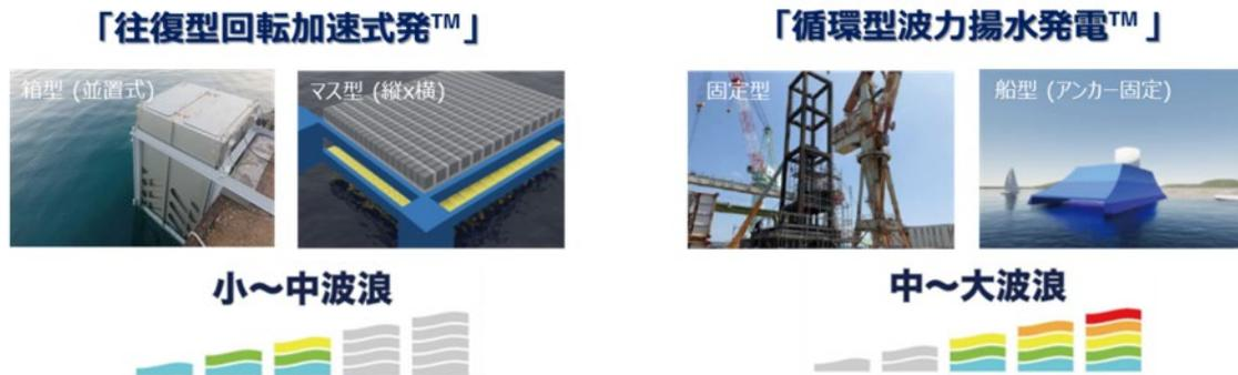
GEH 社の開発する「往復型回転加速式発電」は、小型の発電機を岸壁などに設置し、海面に浮かせたフロートの波による上下動を発電機の回転方向に転換して発電する仕組みです。小さい波にも対応し特殊なギアによりフロートが上下どちらに動いた時でも効率よく発電できる特徴があります。
